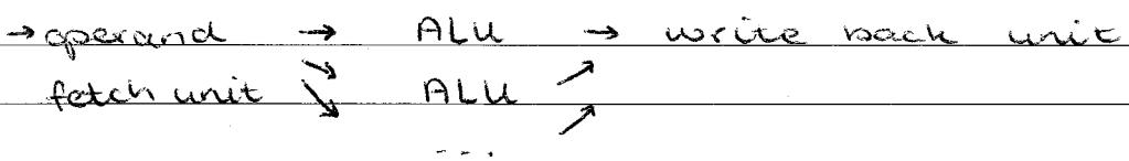
In plaats van een gewone instruction execute unit, maken we gebruik van bovenstaande principe. Vordat de ene instructie helemaal door de nieuwe execute unit is, wordt er ~~er~~ <sup>ook</sup> een andere ingestopt. Zo zullen de instructies sneller na elkaar verwerkt worden, dus zullen er binnen bepaalde tijd meer instructies verwerkt worden.
